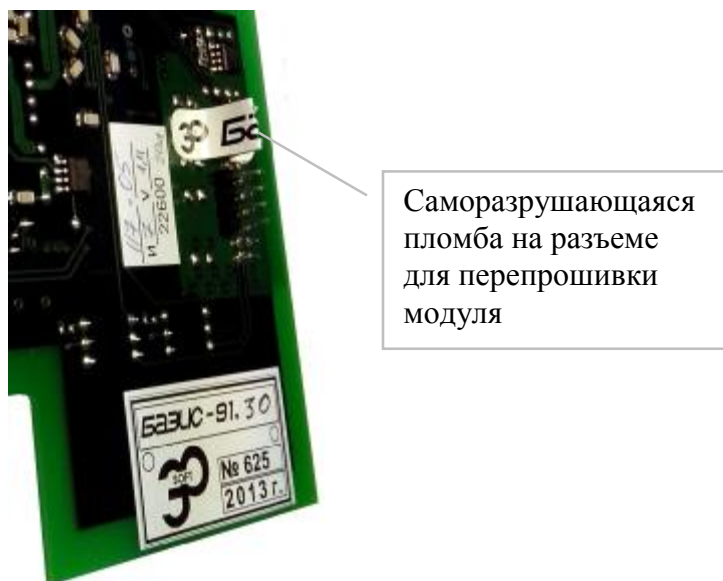
Рисунок 2 — Пломбирование от несанкционированного доступа (фрагмент модуля)
